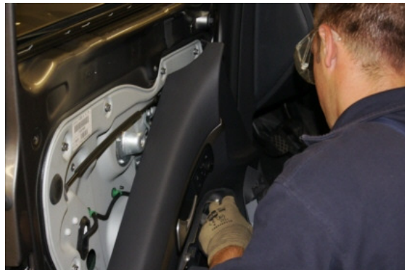
Knifflige Situationen bei der Montage einer Seitenscheibe...
